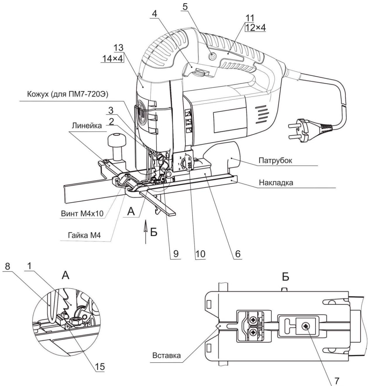
1 - пилка; 2 - винт; 3 - скоба; 4 - клавиша выключателя; 5 - фиксатор; 6 - опора; 7 - винт;
