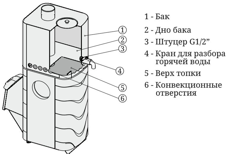
Рисунок 5. Схема присоединения крана для разбора горячей воды
